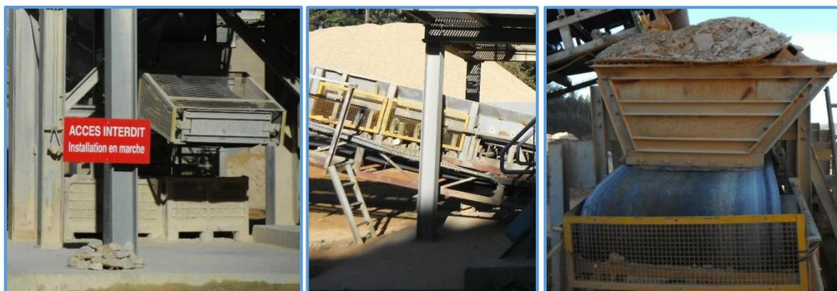
Exemple de carters de protection mis en place sur l'installation de traitement de la carrière de Bazeilles et de Daigny (08) exploitée par la société SCE - Établissement Morgagni.
