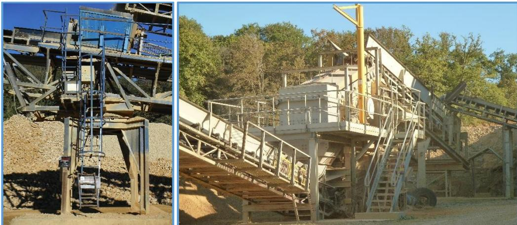
*Échelles et passerelles sécurisées sur l'installation de traitement de la carrière de Bazailles et de Daigny (08) exploitée par la société SCE – Établissement Morgagni.*
